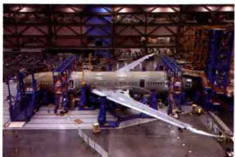
图7 波音787的六大部件对接总装
