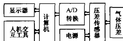
图2 新式试验器流量计的工作原理图
