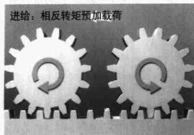
图7 无间隙齿轮齿条传动
