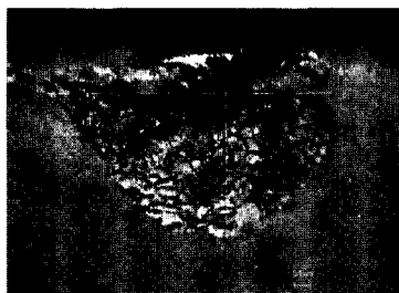
图 3 当量腐蚀 10 a 基体腐蚀损伤
